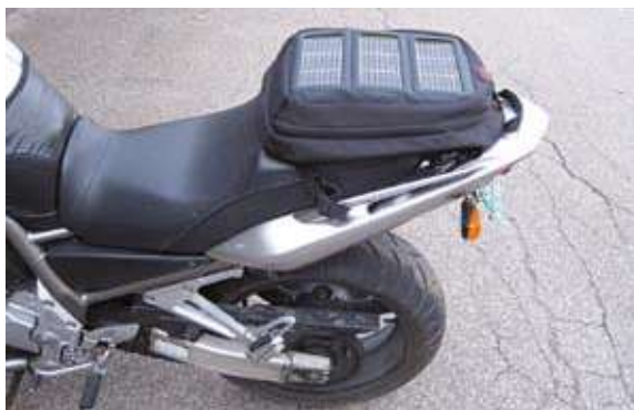
Sakwy z panelami DSSC
