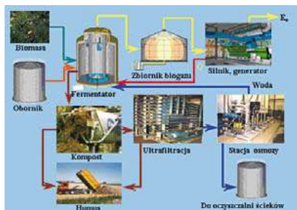
Schemat produkcji biogazu w biogazowni wiejskiej
