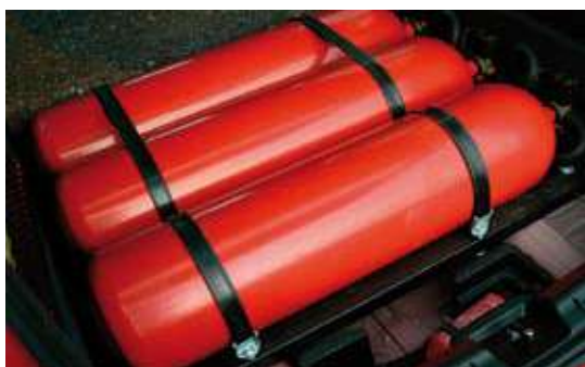
Butle magazynujące gaz ziemny
